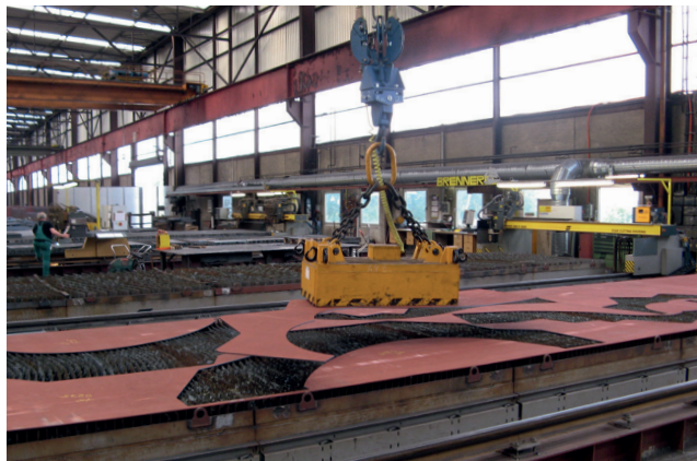
Zuschnitt der 8-mm-Stahlplatten
